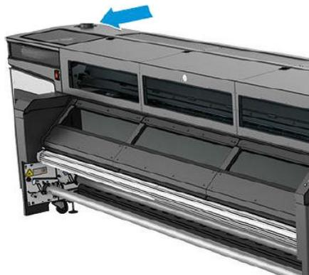
HP recommande d'utiliser le système d'évacuation séparément de l'application. Cependant, pour des applications spécifiques où le collecteur d'encre est utilisé, le système d'évacuation doit être connecté. De plus, HP recommande de diriger l'air d'évacuation en dehors de la pièce.
